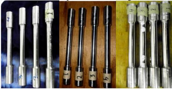
Gambar Spesimen Uji Tarik
